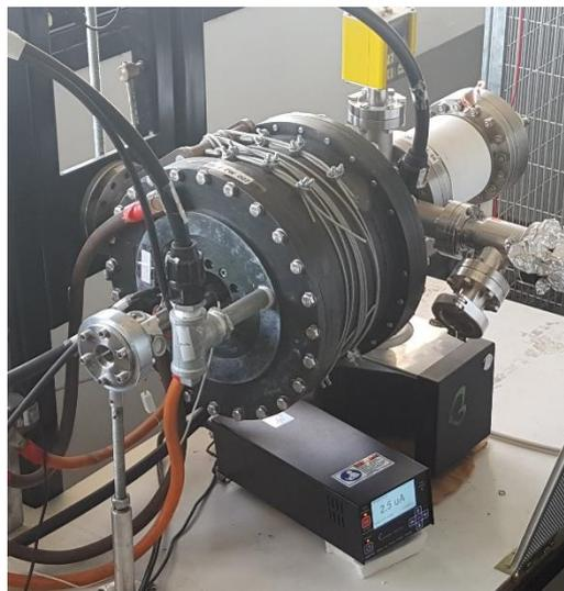
Fig. 1: The 95 GHz gyrotron.
