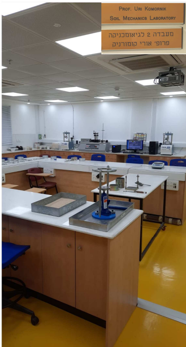
מבט כללי של המעבדה שבה הסטודנטים יכולים לבצע בדיקות ולצפות בתוצאות בזמן אמת תוך כדי ביצוע בדיקות למדידת תפיחה, שקיעה וגזירה של קרקעות
