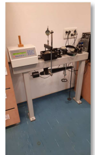
מכשירים לגזירה ישירה של חביות Humboldt ו-ELE למדידת חוזק לגזירה של קרקעות
